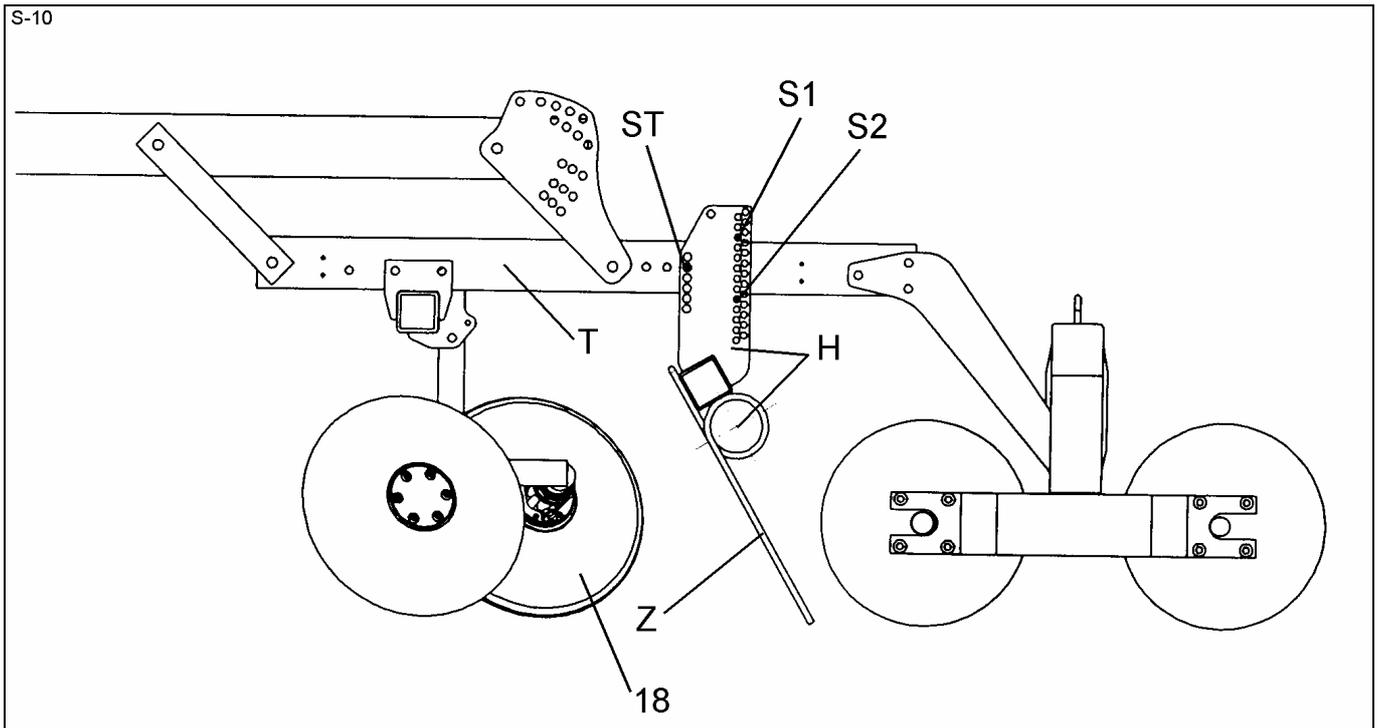
灭茬耙(H)安装在随动辊和凹面耙片(18)之间的下支架(T)上。
