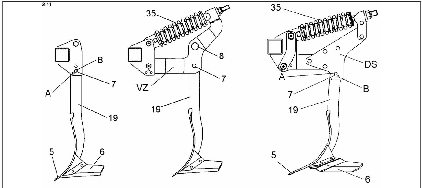
SMARAGD 9 系列联合整地机的耙齿和深松铲位置可以改变。深松铲的角度较小时，可保证平整的松土效果（铲尖(5)和翼型铲(6)的松土深度几乎相同），还降低所需拉力。角度较大时，则确保联合整地机在土壤坚硬干燥时也能顺利松土。在带保险螺栓的 SMARAGD 9 型联合整地机和带螺栓固定分体式耙齿固定座(DS)的 SMARAGD 9 Ü 型联合整地机上，改变保险螺栓(7)的固定位置，即可调整耙齿位置以及深松铲位置。
