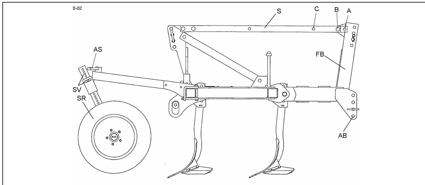
Smaragd 9、9 S、9 Ü 和 9 S Ü 联合整地机能与一台推进装置（也可用于前置作业）配套使用。但必须将平行杆连同凹面耙片和耙辊一起拆除，并安装一个用作推进装置的前置安装架 (FB)。
