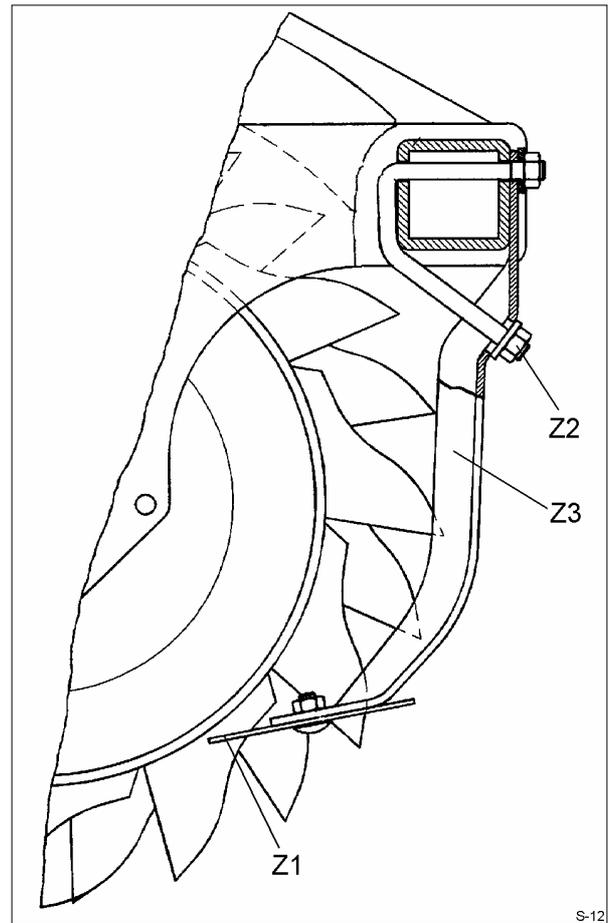
刮板 (Z1) 可随意调整，其位置需要定期校正。用刮板固定杆 (Z3) 的紧固螺母 (Z2) 进行调整。如果耙辊滚筒上结有土壤，则必须调整刮板。硬结在耙辊滚筒上的土块会增加磨损并损坏刮板 (Z1)。因此在继续作业前必须先清除土块。
