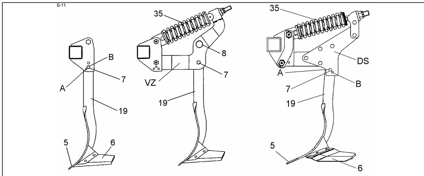
每根耙齿(19)和耙片支架均装有一枚保险螺栓(7)，用于双横梁、耙齿和耙片支架的过载保护。保险螺栓(7)断裂后的操作如下：
