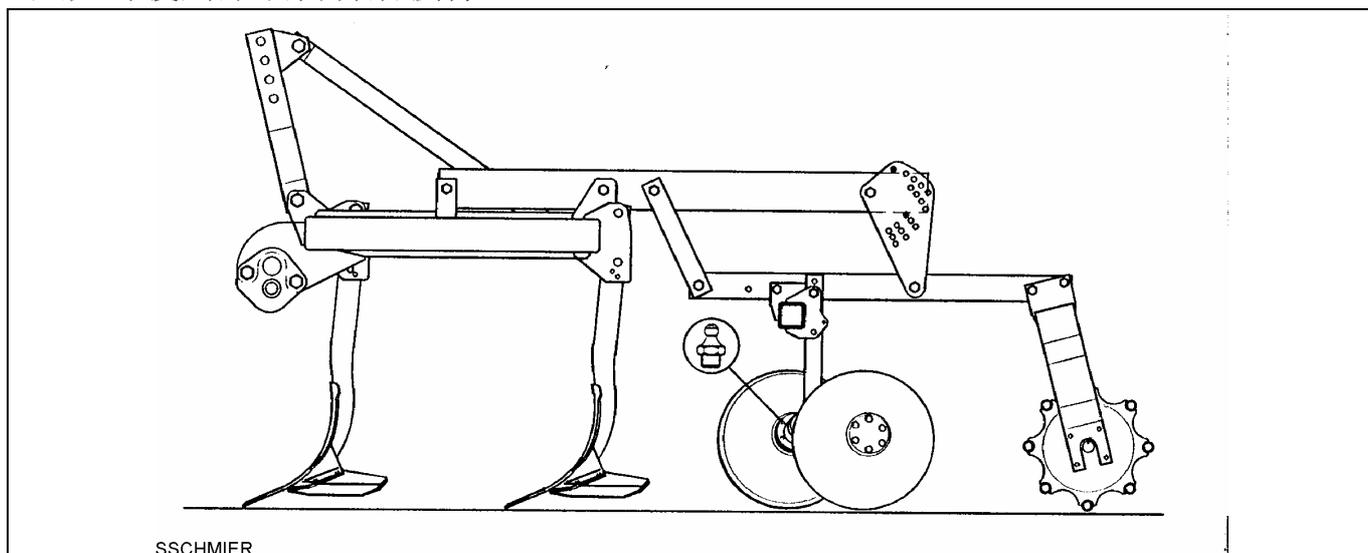
**重要：** 前 6 周不可使用蒸汽喷射清洗机冲洗属具。之后，喷嘴距离必须保持 60 cm，最大压力 100 bar，温度 50°C。
