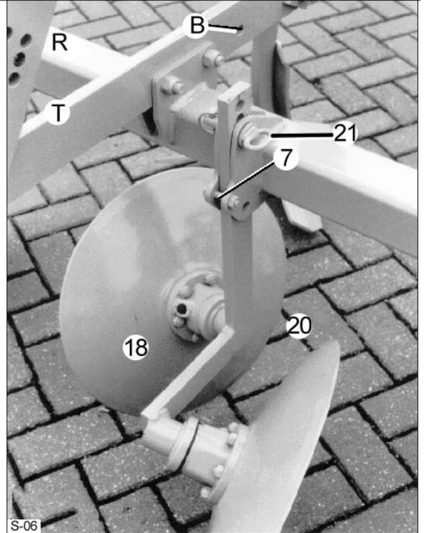
只要对凹面耙片的深度作了一次调整，就无需再对耙齿的作业深度调整进行校正。
