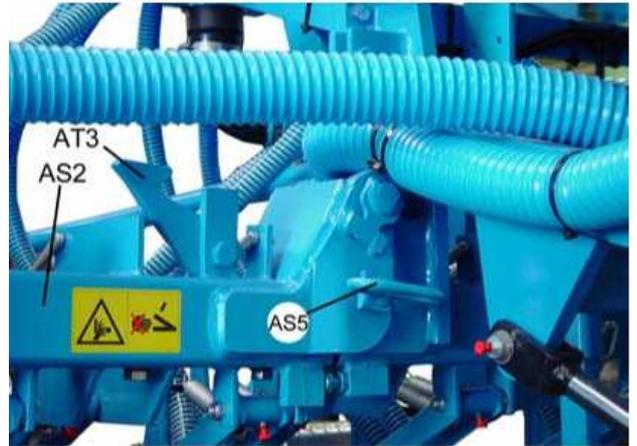
通过操作相应的拖拉机控制器折叠或展开排种轴 (AS2)。排种轴通过固定钩 (AT3) 自动折叠锁定。
